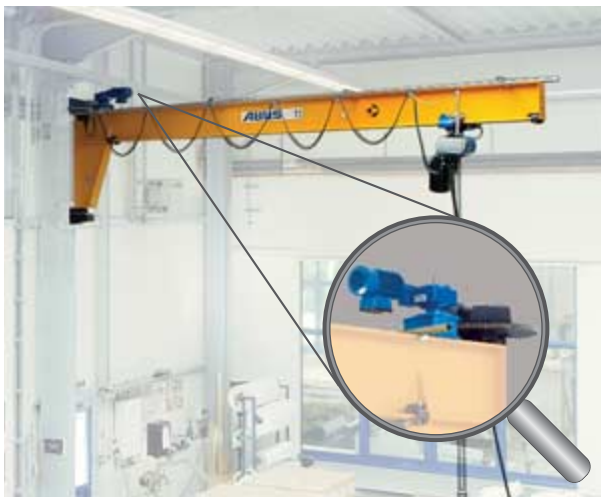
Giro eléctrico del brazo (fig. 3)
